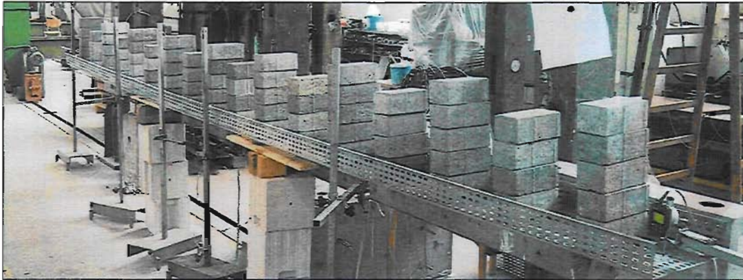
Obrázek 6: Žlab L1 300/100 při zkoušce – 48,1 kg/bm
