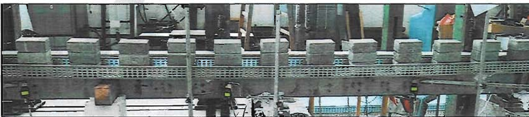
Obrázek 3: Žlab L1 200/100 při zkoušce – 32,6 kg/bm
