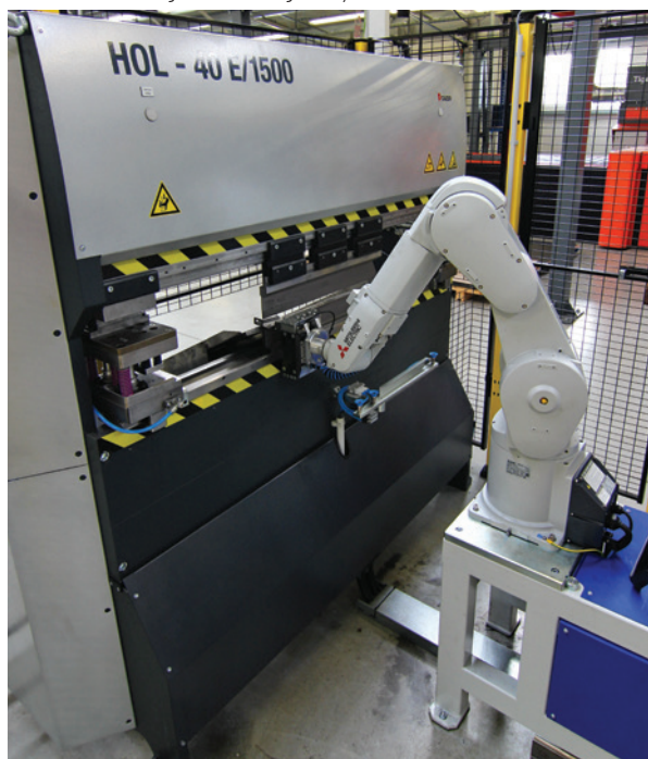
▶ Jedno z robotycznych stanowisk produkcji giętych elementów z blachy w zakładzie produkcyjnym ARKYS.
