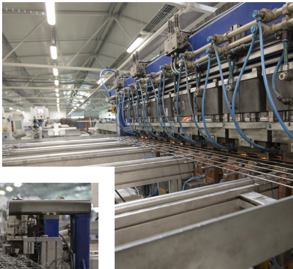
◀ ▶ Średnioczęstotliwościowe centra do zgrzewania drucianej konstrukcji korytek MERKUR2.
